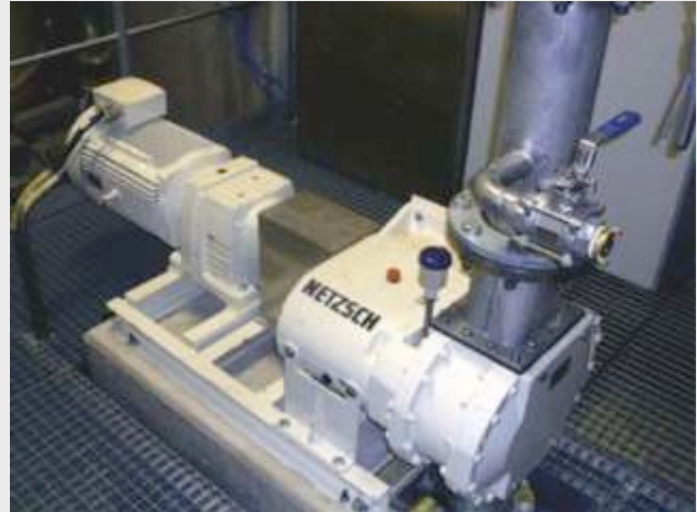
Una TORNADO® T1 T1 en uso en una usina de papel. Tanques de caolina son descargados a 75 m 3 /h contra una presión de hasta 4 bar.
